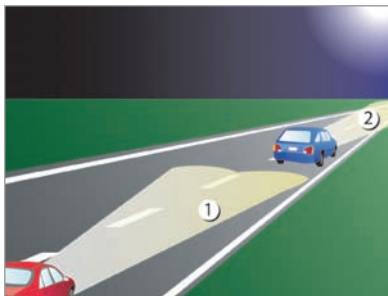
El que pretende adelantar (1) cambia la luz alta por la baja tan pronto como pueda deslumbrar.
