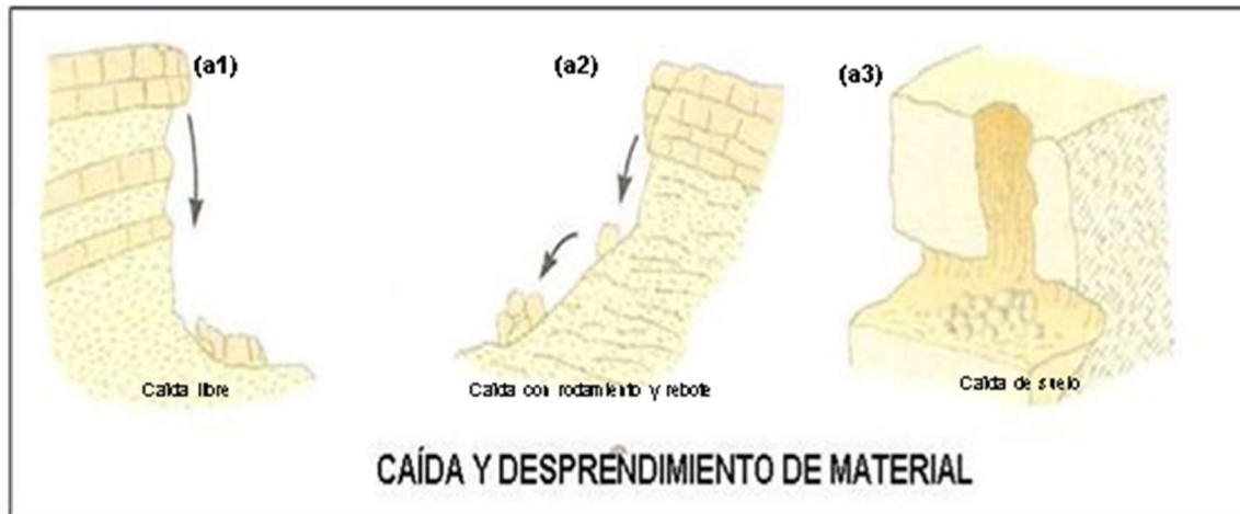
Figura 17 Remociones en Masa de tipo Caídas de Rocas
